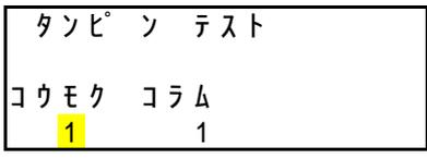
タンピンテスト<br>コウモク コラム<br>1 1                       |
